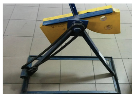
Рис. 11. Установка для проведения испытаний кабелей на стойкость к изгибу
