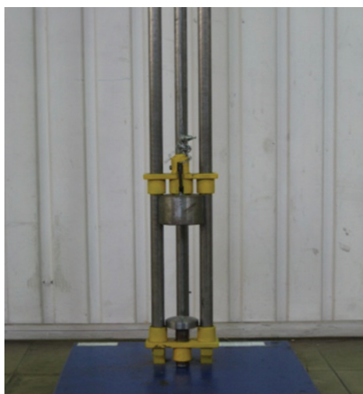
Рис. 5. Установка для проведения испытаний кабелей на стойкость к удару
