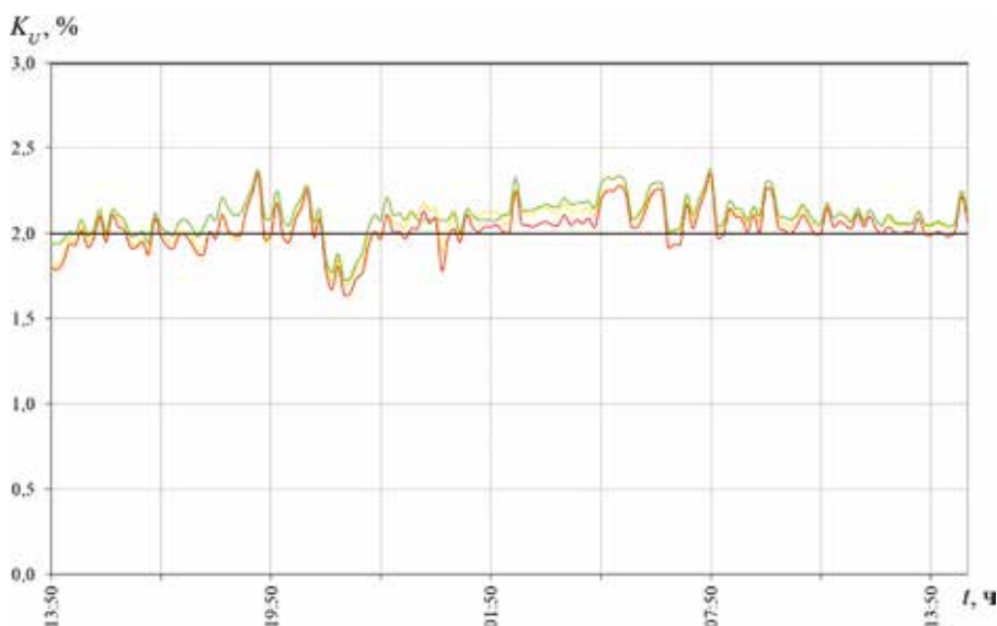
Рис. 5. График изменения суммарного коэффициента гармонической составляющей междуфазных напряжений в линии Л-ТАЗ1 за период 15.07.2015 г. (13:57) — 16.07.2015 г. (15:03):
